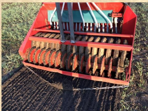
Grondbewerking en zaaien in één bewerkingsgang
